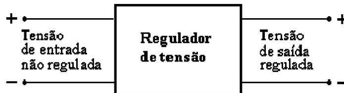
Os reguladores de tensão podem ser implementados com componentes discretos ou podem ser obtidos na forma de circuito integrado. Os reguladores de tensão na forma de CI são mais precisos e tornam o circuito mais compacto, pois ocupam menor espaço.
