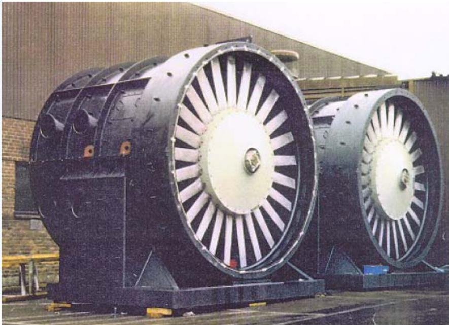
Sistema de ventilação do túnel sob o Canal da Mancha
